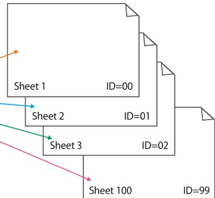
お客様が自分でマクロプログラムを作成することなく、複数の測定器(U-WAVE-TM/TC/T)から別々のエクセルシートへのデータ振り分け処理が可能になる。
