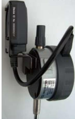
● 主な測定器への着脱シートの取り付けイメージ
